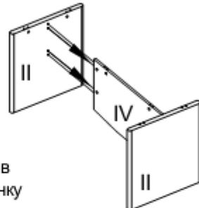
Положить столешницу (I) отверстиями вверх. Забить в столешницу (I) шканты (1) и цанговые футорки (4). Вкрутить в цанговые футорки дюбеля (3) до упора в обод. Надеть столешницу (I) на каркас и затянуть отверткой стяжки-эксцентрики (2) на стенках боковых (II) и планке продольной (IV). Закрыть торцы стяжек-эксцентриков декоративными заглушками (7). Отрегулировать, при необходимости, высоту конференц-приставки, подвинув опоры (5).
