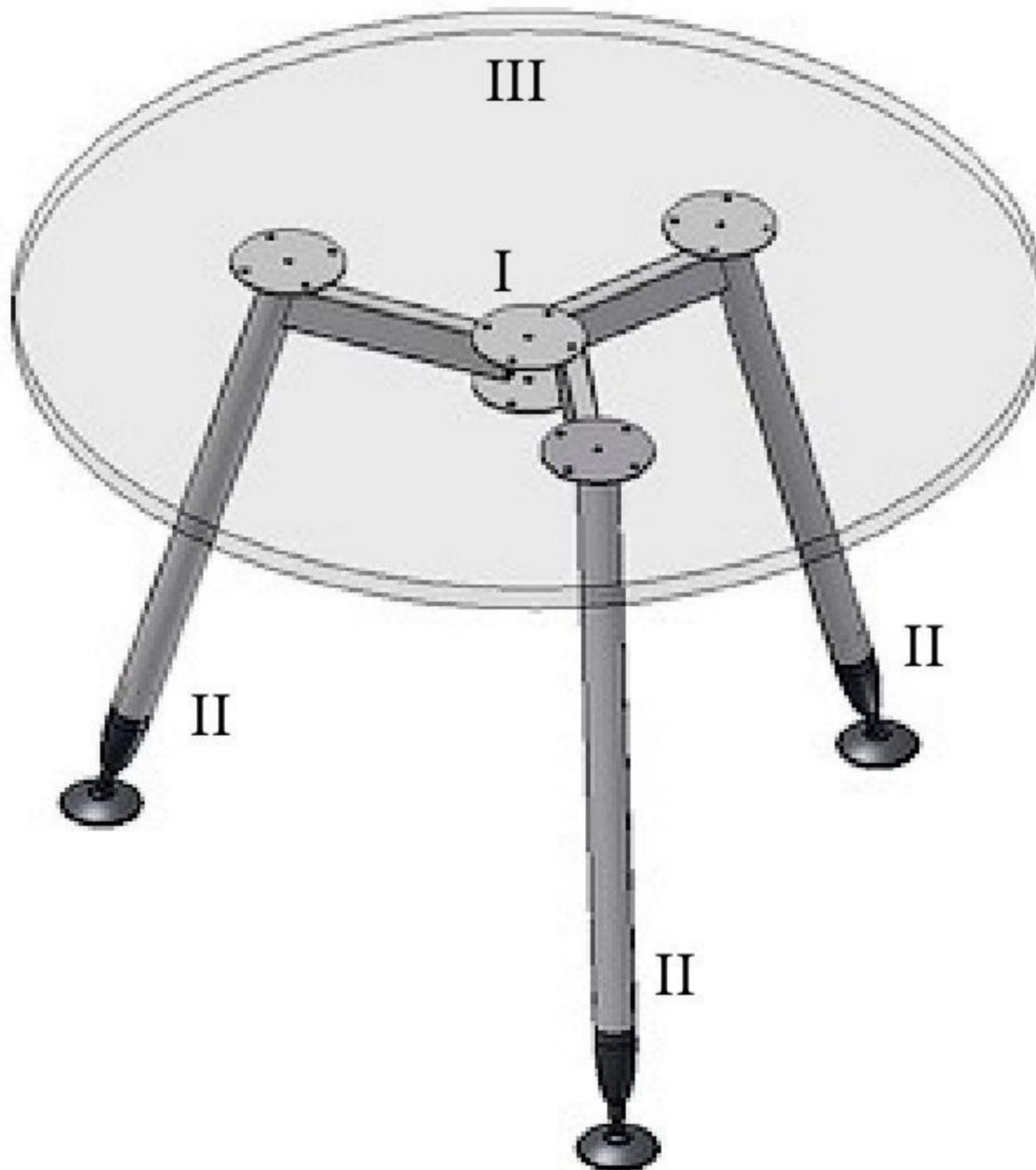
Положить столешницу (III) на чистую ровную поверхность. Положить сверху металлический каркас и при помощи саморезов (1) прикрутить столешницу через отверстия в опорах. Для облегчения сборки столешница имеет по одной наковке на каждый узел (ногу).
