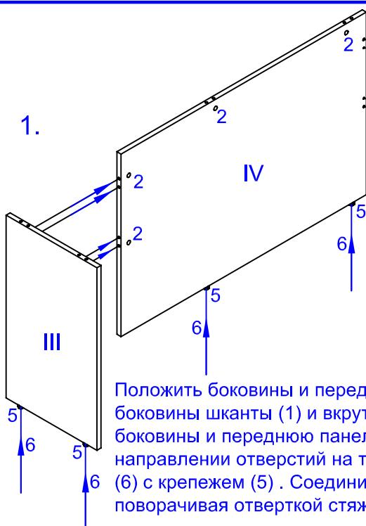
Положить боковины и переднюю панель отверстиями вверх. Вбить в боковины шканты (1) и вкрутить дюбеля стяжек-эксцентриков (3). Вставить в боковины и переднюю панель стяжки-эксцентрики (2) стрелкой в направлении отверстий на торцах. Забить в боковины регулируемые опоры (6) с крепежем (5). Соединить боковины и переднюю панель. Стянуть каркас, поворачивая отверткой стяжки-эксцентрики (2) по часовой стрелке.
