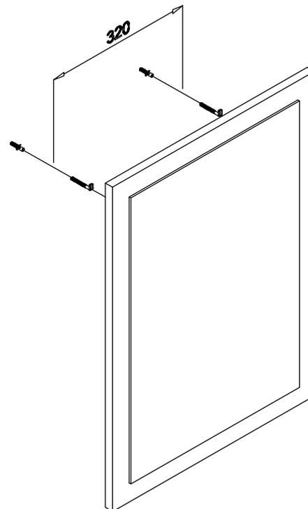
**ВНИМАНИЕ!** Комплект фурнитуры, вложенной в состав поставки, обеспечивает навеску зеркала только в одном положении! При желании перевесить зеркало в другое положение необходимо переставить одну зубчатую навеску (1) см. рис.1 и докупить дополнительную крепежную фурнитуру (2,3).
